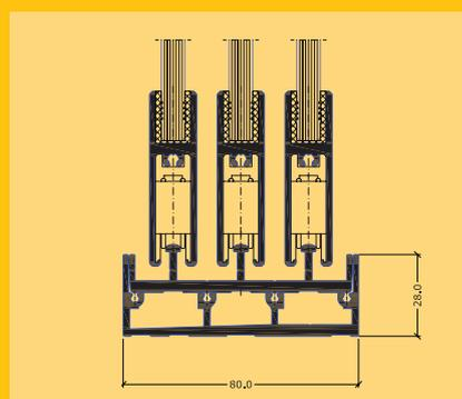
Bodenschiene 3 spurig mit Entwässerungsprofil
